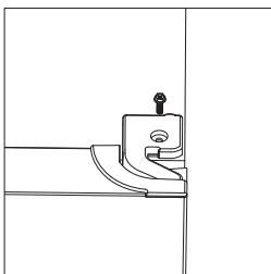
2. Ξεβιδώστε και αφαιρέστε τον πείρο του μεντεσέ, γυρίστε τον βραχίονα και επανατοποθετήστε τον
