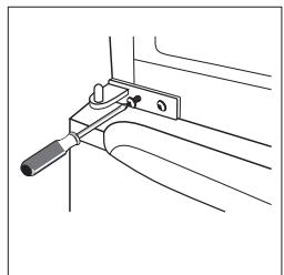
11. Επανατοποθετήστε την πόρτα. Βεβαιωθείτε ότι η πόρτα είναι ευθυγραμμισμένη οριζόντια και κάθετα και ότι είναι σφραγισμένο από όλες τις πλευρές πριν σφίξετε τον επάνω μεντεσέ. Στη συνέχεια, αφήστε το επάνω μεντεσέ και βιδώστε το στην κορυφή της μονάδας και στη συνέχεια στερεώστε το κάλυμμα του μεντεσέ.
