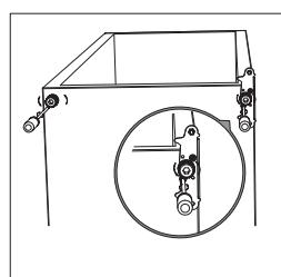
8. Ξεβιδώστε και αφαιρέστε τον κάτω πείρο του μεντεσέ, γυρίστε τον βραχίονα και επανατοποθετήστε τον
