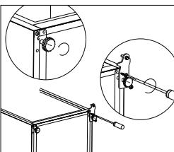
8. Ξεβιδώστε και αφαιρέστε τον κάτω πείρο του μεντεσέ, γυρίστε τον βραχίονα πάνω και επανατοποθετήστε τον
