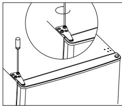
14. Insurubati capacul balamalei si acoperiti orificiul din partea superioara a unitatii.
