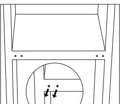
7. Τοποθετήστε το πίσω μέρος του θαλάμου σε μία μαλακή επιφάνεια. Και ξεβιδώστε την κάτω άρθρωση και τα ρυθμιζόμενα πόδια.
