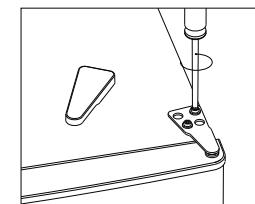
3. Scoateti capacul orificiului cu o surubelnita cu lama plată.
