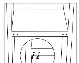
11. Ridicati unitatea si asezati usa pe balama inferioara. asigurati-vă ca capacul balamalei inferioare este introdus in orificiul usii. Apoi deplasati capacul balamalei inferioare a usii din partea stanga in partea dreapta.
