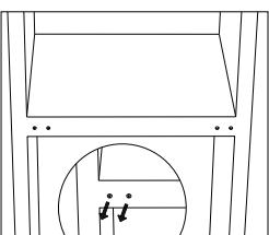
7. Asezati partea din spate a dulapului pe o suprafata moale si desurubati balamaua inferioara si picioarele reglabile.
